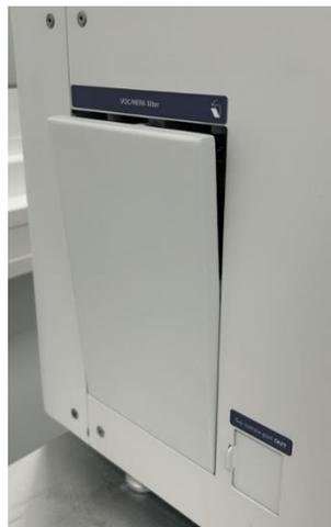
Abbildung 12.1 Die Drucköffnungsklappe
