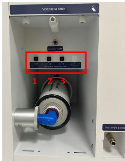
**Abbildung 22.1** Anschlüsse von PT-1000-Sensoren der Klasse B
