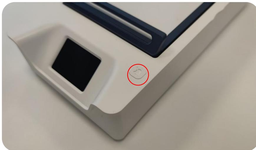
Abbildung 15.4 Schaltfläche zum Stummschalten des Alarms
