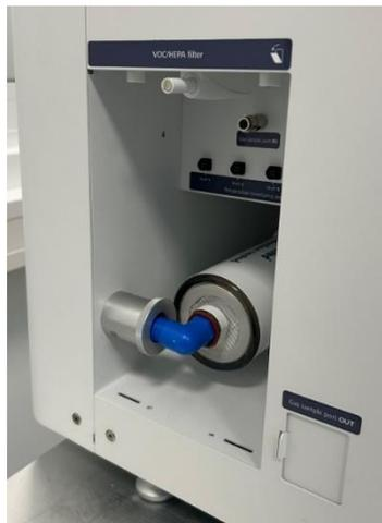
**Abbildung 12.3** Blauer Winkelanschluss des Filters eingesetzt
