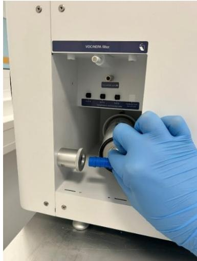
**Abbildung 12.6** Ausgeworfener blauer Winkelanschluss des Filters
