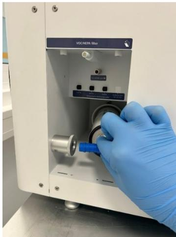
**Abbildung 12.2** Gerader blauer Filteranschluss eingesetzt
